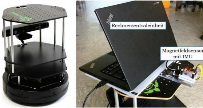
Abb. 4. Mobile Roboterplattform (links) und Versuchsaufbau mit Magnetfeldsensor-IMU-Kombination (rechts).
