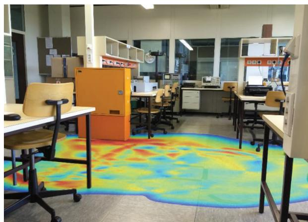
Abb. 6. Exemplarische Karte der horizontalen Flussdichte des Labors für Mess- und Sensortechnik.
