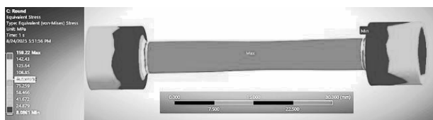
Abb. 4. Äquivalentes Spannungsfeld (von-Mises-Spannung) in der Zugprobens aus AE42 für unterschiedliche Porositätsgrade, ermittelt durch FEM.
