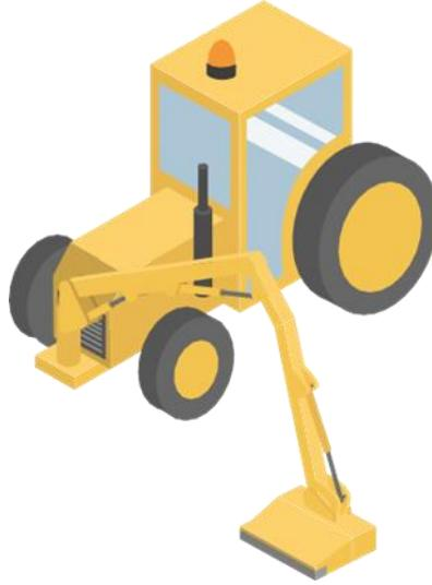
Abb. 1. Die Skizze des Simulationsmodells, welches ein Fahrzeug (Traktor, Lastkraftwagen o.ä.) und einen hydraulischen Manipulator mit vier Gelenken enthält.
