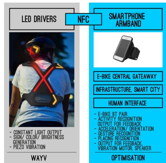
Abb.1. Beispiel: WAYV [6] (links) und Optimierungsvorschlag: Adressierbare LED/Buzzer-Signalstruktur (rechts).
