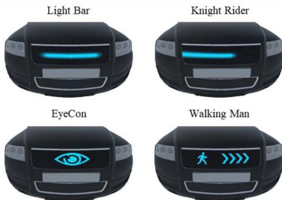
Abb. 4. Beispiel einer Kommunikationsstrategie angewendet bei Konzept für autonome Fahrzeuge; [21]
