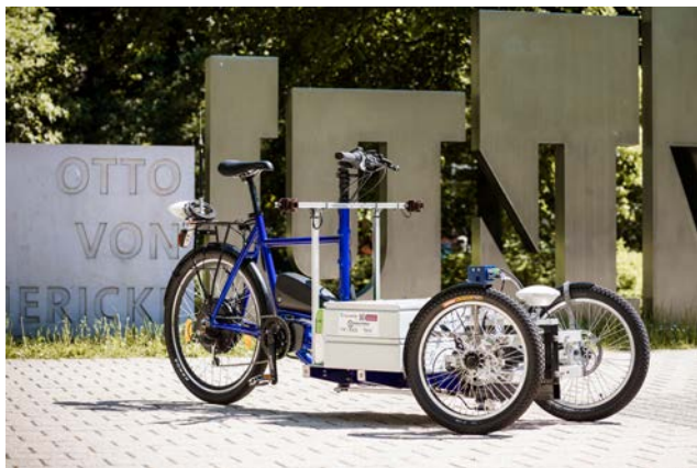
Abb. 3. Der Prototyp von AuRa ist auf Basis eines Lastenfahrradmodel Typ X-Loader aufgebaut. Foto: Jana Dünnhaupt/OVGU
